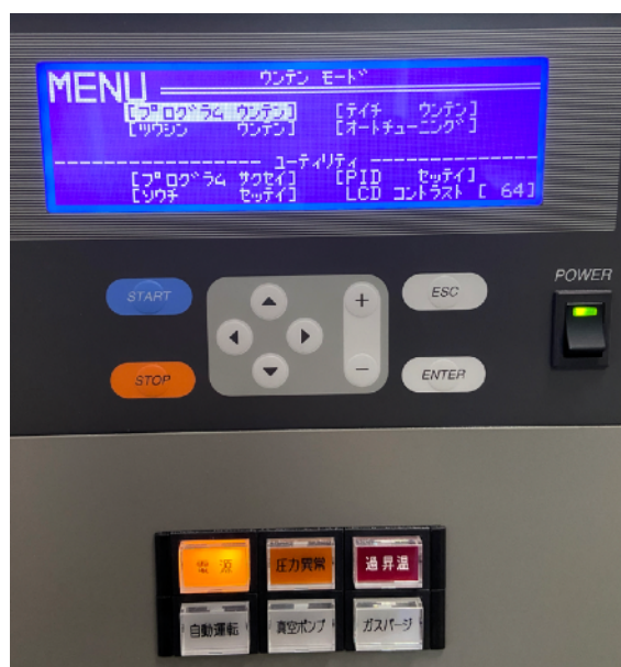
操作パネル（上側）と表示ランプとスイッチ類（下側）
