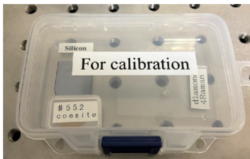
Photo 10. 調整や校正に使っている合成 coesite、Siとダイヤモンド。coesiteはエポキシ接着剤の中心部にあり、周りを白金に囲まれている。ダイヤモンドは壊れたDAC用アンビルをテーブル面を上にしてスライドグラスに接着したもの。単結晶Si板も入っている。
