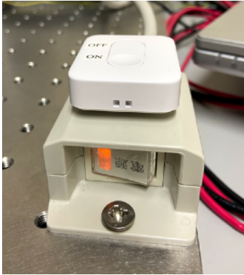
Photo 8. テーブルトップの電源スイッチ。上に乗っている白いボックスは室内照明のON/OFFスイッチ。手前側が照明ONで、奥側が照明OFF。
