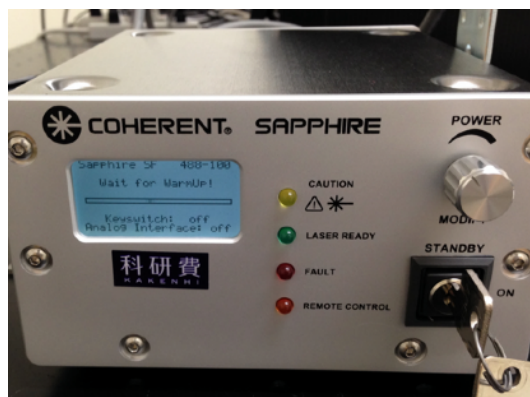
Photo 6. Coherent Sapphire 488 nm レーザーのコントローラーの前面部。電源スイッチは後にある。
