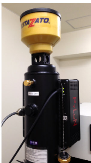
Photo 5. 専用ロート（と倒さないための黒いキューブ） をCCD検出器デュアーの先端に取り付けたところ
