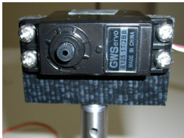
photo 2. サーボモーターの取り付け部分。黒のまだら部分が自作したアダプタ。下側の棒はソーラボのポストで、M4ネジでアダプタを止めている。中央やや左に軸についたギヤが見える。滑車の中央がここにはまるようになっている。
