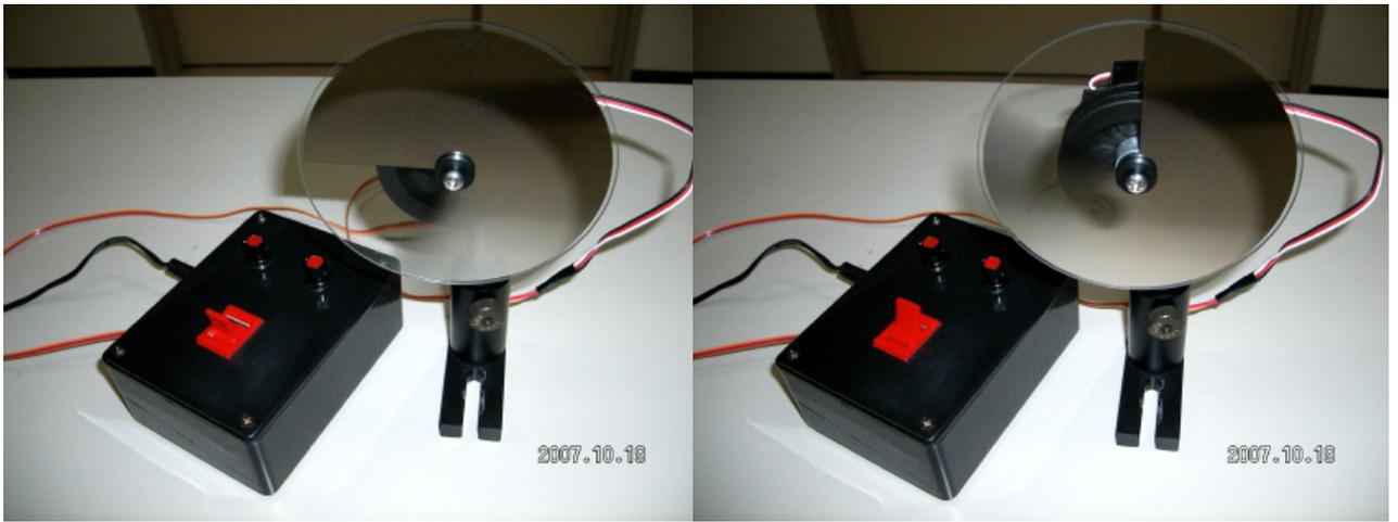
photo 3. 左は常時位置にスイッチを倒した時、右はアクション時位置にスイッチを倒した時の状況。フィルターが90度ほど回転している。
