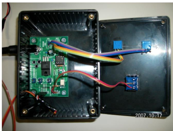
photo 1: PICアクチュエーターキット基板と外部可変抵抗(右上の2つ)、スイッチ(右下)、左側の外部への配線はDC9V(上)とモーター(下)へ。
